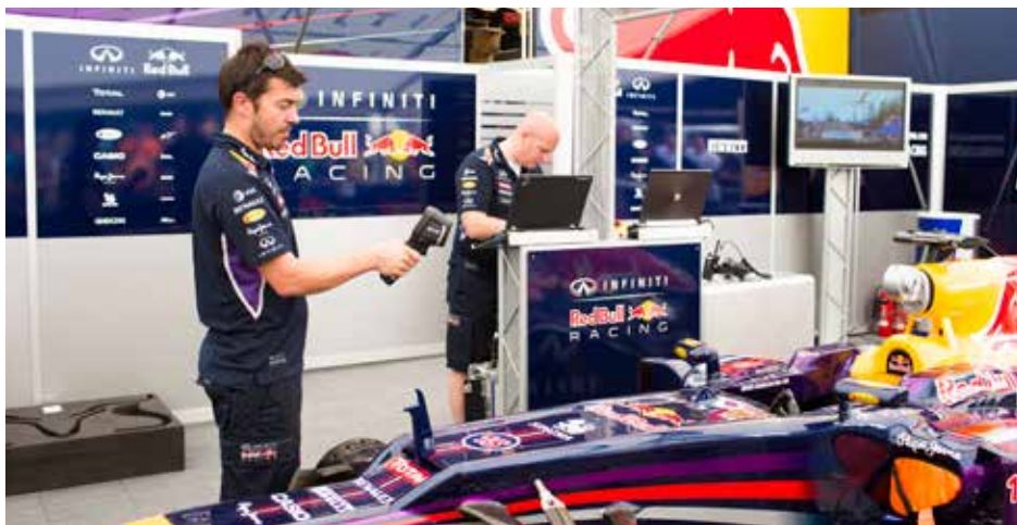
Simple à utiliser, la caméra d'imagerie thermique portable FLIR Ex vous permet de mesurer et de visualiser les températures rapidement, où que vous soyez.
